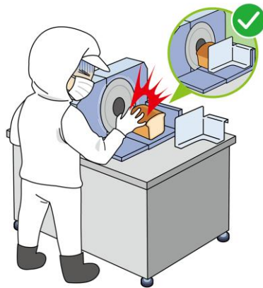
スライサーに手が触れ、手が切れている作業員のイラスト(用具を使用していないイラスト) 注意喚起文10.「運転中は手で触るな」、11.「機械が動いている時は手で触るな」、15.「清掃時/点検時/修理時⇒機械停止」と組み合わせて使用することが推奨されます。
