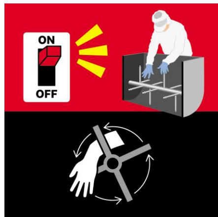
混合機のスイッチをONにしたまま機械に手を入れたため、かはん部分に手が巻き込まれているイラスト 注意喚起文7.「運転中は手を入れるな」、8.「機械が動いている時は手を入れるな」、12.「用具を使う」、15.「清掃時/点検時/修理時⇒機械停止」と組み合わせて使用することが推奨されます。
