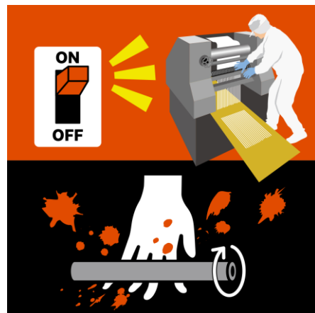
ロール機のスイッチをONにしたまま機械に手を入れたため、ロール部分に手が巻き込まれているイラスト 注意喚起文7.「運転中は手を入れるな」、8.「機械が動いている時は手を入れるな」、12.「用具を使う」、15.「清掃時/点検時/修理時⇒機械停止」と組み合わせて使用することが推奨されます。
