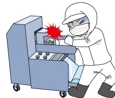
包装機に手が巻き込まれている作業員のイラスト 7.「運転中は手を入れるな」、8.「機械が動いている時は手を入れるな」、15.「清掃時/点検時/修理時⇒機械停止」と組み合わせて使用することが推奨されます。
